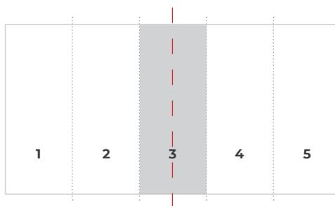
Dans le cas d'un nombre impair de lés, l'assemblage doit partir du lé central et s'effectuer en faisant coïncider l'axe de celui-ci avec le centre du mur qui vient d'être identifié.
