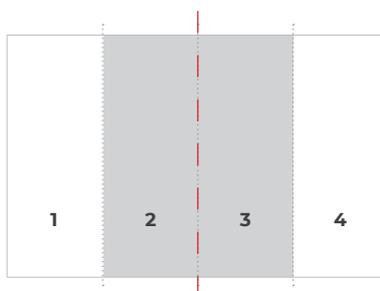
Dans le cas d'un nombre pair de lés, par contre, l'assemblage doit être effectué de telle manière que le joint des deux lés centraux tombe le long de la ligne qui identifie le centre du mur ; la pose peut démarrer indifféremment à partir de l'un des deux lés centraux précédemment mentionnés.
