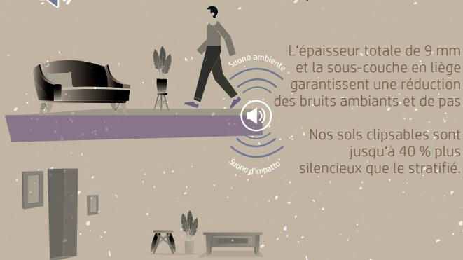
L'épaisseur totale de 9 mm et la sous-couche en liège garantissent une réduction des bruits ambiants et de pas
